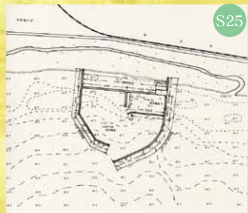
昭和25年に北海道港湾課が計画した「苫小牧漁港」掘り込み式ではなく、防波堤で囲った小規模なもの
