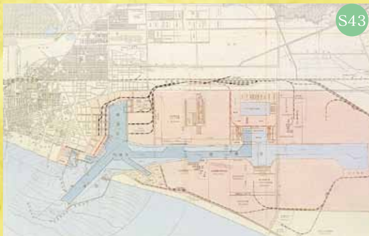
昭和43年の苫小牧港管理組合による苫小牧港整備計画図略図。現在は埋め立てられた木材の水面貯木場（東側水路の上部）が見られる
