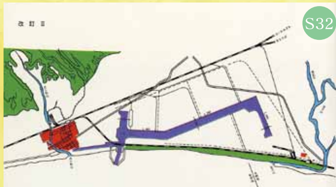
昭和32年、北海道開発庁による計画図。東側の水路が鉄道と平行に伸びるように変更されている
