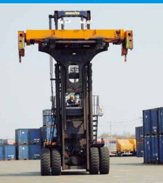
コンテナを吊り上げるトップリフター
