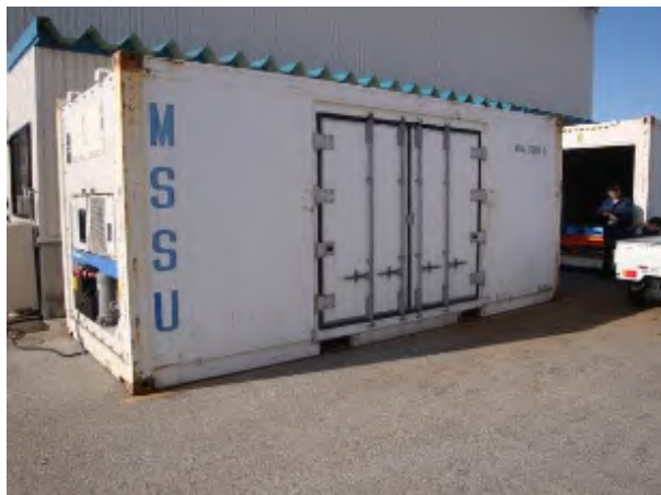
保冷実験に利用したリーファーコンテナ
