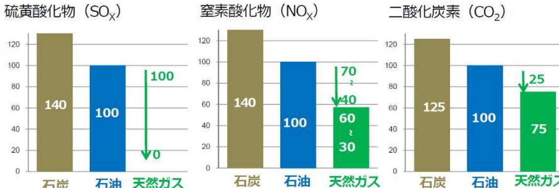
石油を燃焼した際に排出される硫黄酸化物、窒素酸化物、及び二酸化炭素を100とした時に石炭及びLNGを燃焼した際の相対値
