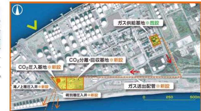
※CCS: Carbon dioxide Capture and Storageの略で、発電所や工場などから排出されるCO<sub>2</sub>を含んだガスからCO<sub>2</sub>を分離・回収して地中に送り込み、地下深くの安定した地層の中に貯めることで、大気中に放出されるCO<sub>2</sub>を削減する技術
