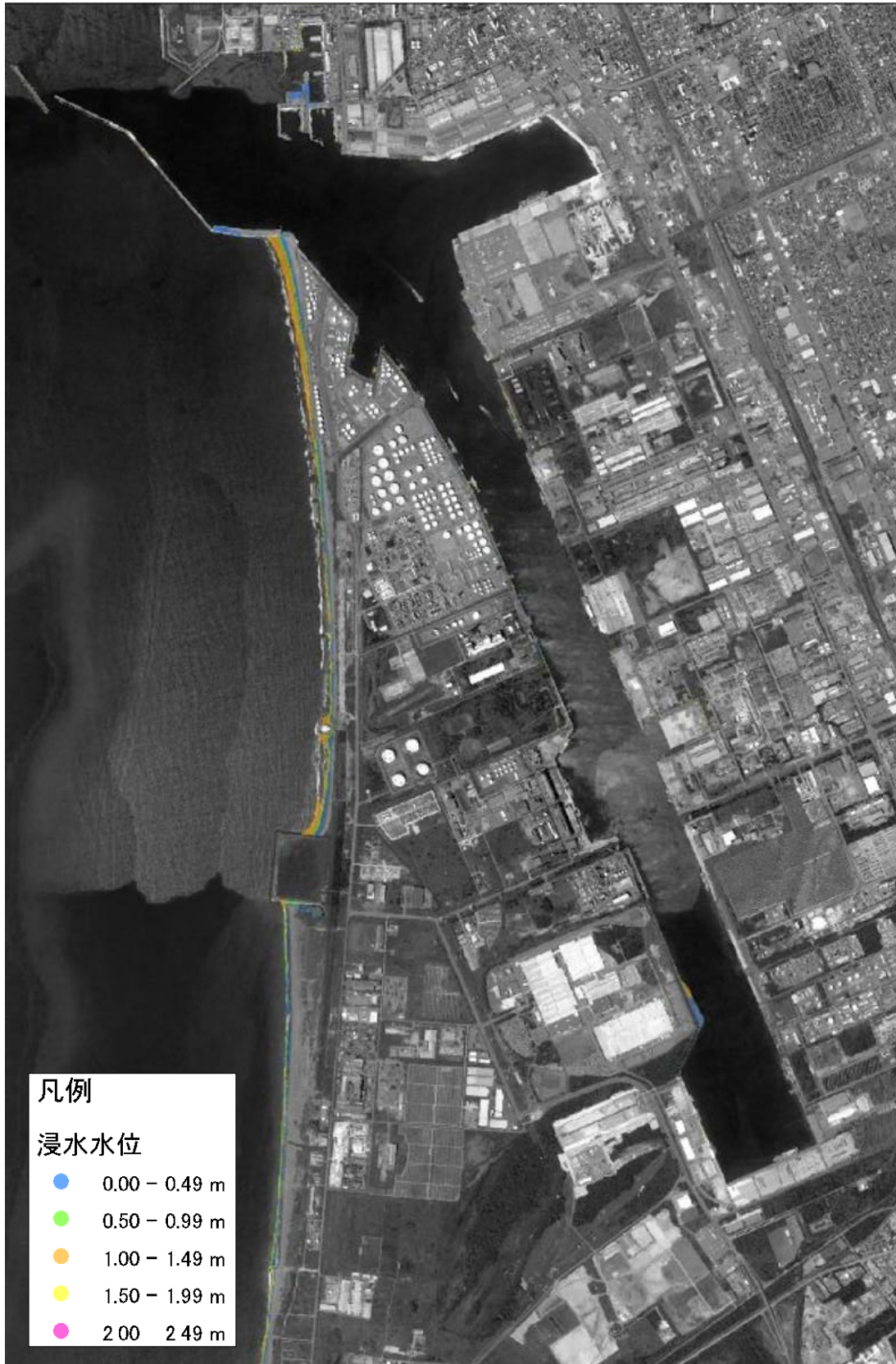
図 参 5-1 苫小牧西港の浸水図 (2°C上昇満潮時、水位：TP+1.13m)
